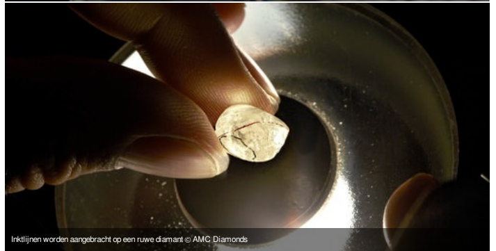
Inktlijnen worden aangebracht op een ruwe diamant © AMC Diamonds
